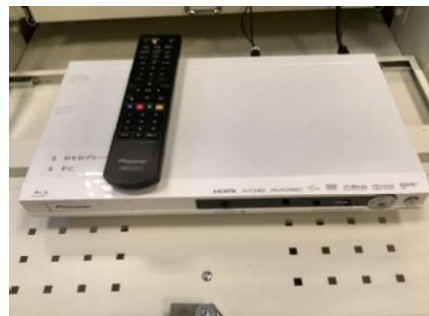
プロジェクター台の中に収納 (単独使用可) 天井スピーカー使用 HDMIケーブルにてプロジェクター接続 W360×D200×H35
